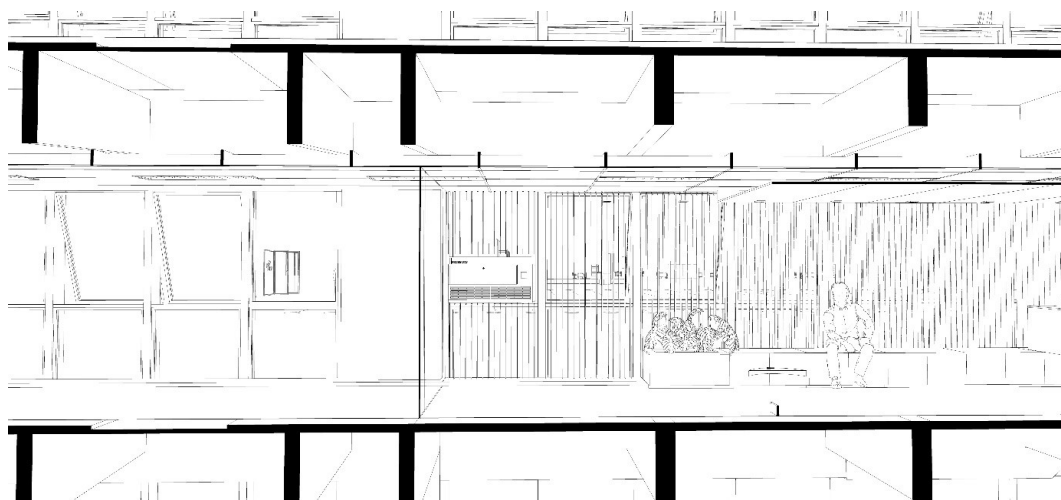
Figura 01: Na imagem acima podemos ver o vidro temperado em corte, a estrutura do forro que encontra o vidro temperado em corte e a estrutura de concreto armado que servirá de apoio à estrutura de reforço ao vidro temperado. Destaque para a existência de uma viga muito próxima ao ponto de apoio do vidro.
