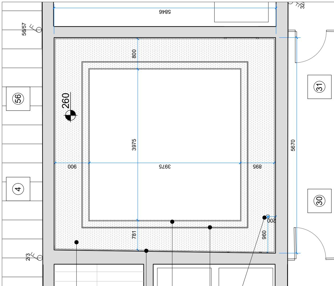
REBAIXO DE GESSO ACARTONADO LISO. PLACAS DO TIPO STANDARD COM BORDAS REBAIXADAS, NÍVEL 2,60M. ÁREA 16,36M<sup>2</sup>. JUNTAS TRATADAS COM MASSA DE REJUNTE PARA DRYWALL E FITA DE PAPEL MICROPERFURADO. NIVELAMENTO COM MASSA PVA E PINTURA COM TINTA PVA BRANCO NEVE. OBSERVAR POSIÇÃO DAS DICRÓICAS PARA POSICIONAMENTO DOS PERFIS METÁLICOS
