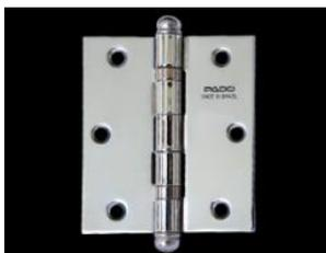
As dobradiças para as portas serão em aço inox polido, 3 unidades por porta, com rolamento em aço e lubrificação permanente, dimensões 3x3", MODELO: 3530 de fabricação PADO ou similar.
