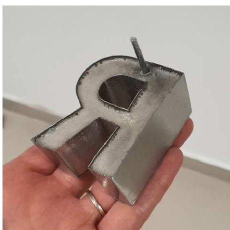
Figura 07. Exemplo de letra tipo caixa, preenchida com resina e pino de fixação inserido.
