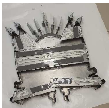
Figura 05. Exemplo de superfícies planas soldadas e a aplicação de fita dupla-face e cola PU. O brasão a ser produzido deve possuir os pinos de sustentação conforme descrito acima.
