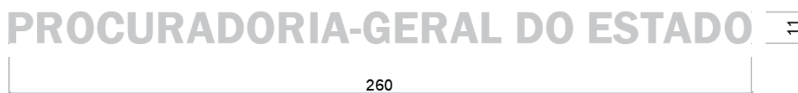
Figura 06. Letreiro 1, tipo caixa em inox, altura 11cm, profundidade 2,5 cm.
