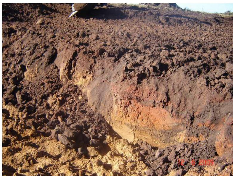
Foto 38 – Vista geral do perfil da Jazida da Ombreira Direita da Barragem Arroio Jaguari – vê-se que a camada de solos areno-argilosos de cores avermelhadas apresenta pouca espessura, estimando-se, no geral, valores da ordem de 0,5m até ~1,0m
