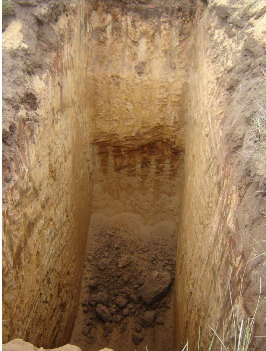
Foto 3 – Vista geral de um corte do perfil de alteração da margem esquerda nas proximidades da estaca 09 e do vertedouro – perfil constituído de areia média e grossa siltosa amarelada medianamente compacta e areia média e grossa siltosa com pedregulhos (saibro) compacta e na base da cava a rocha granítica decomposta ou muito alterada
