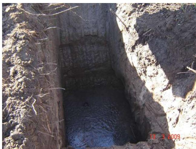
Foto 24 – Vista da cava de uma trincheira de inspeção no trecho da várzea do Arroio Jaguari – superficialmente vê-se a camada de argila orgânica preta com consistência de mole a dura e subjacente os solos arenosos aluvionares de compactidade de fofa a pouco compacta. No fundo da cava pode-se verificar a presença da água freática e a instabilização da areia por fluxo ascensional na medida do aprofundamento da escavação, sem rebaixamento do NA freático
