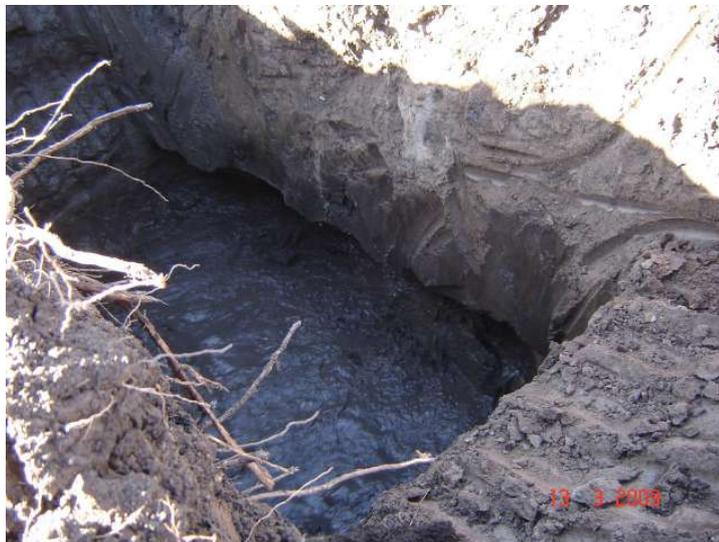
Foto 25 – Idem foto anterior – pode-se ver perfeitamente o contraste de granulometria da camada superficial orgânica de cor escura e as areias aluvionares marrom claro, sem coesão e com alta permeabilidade. A camada argilosa apresenta baixa permeabilidade e as areias, no geral, alta – após a estabilização dos fluxos laterais e ascensionais o NA se estabilizava no limite da camada argilosa orgânica impermeável
