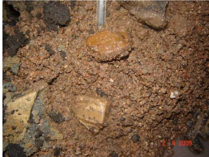
Foto 35 – Detalhes da areia média e grossa com pedregulhos compacta de camadas de pouca profundidade a imagem mostra os pedregulhos e/ou cascalhos de cores e litologias variadas que são descritas nas sondagens
