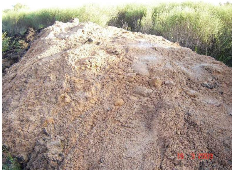
Foto 33 – Vista geral do material arenoso (areia média e grossa com pedregulhos e cascalhos finos de cores e litologias variadas) escavado na TRI – 34 eixo mais 10m para montante
