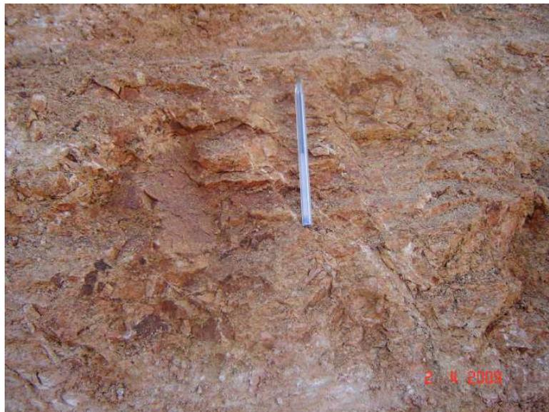
Foto 19 – Detalhes da rocha granítica decomposta da Ombreira Direita da barragem - maciço rochoso com fraturamento milimétrico, o que é comum em todos os cortes, confirmando as descrições das sondagens
