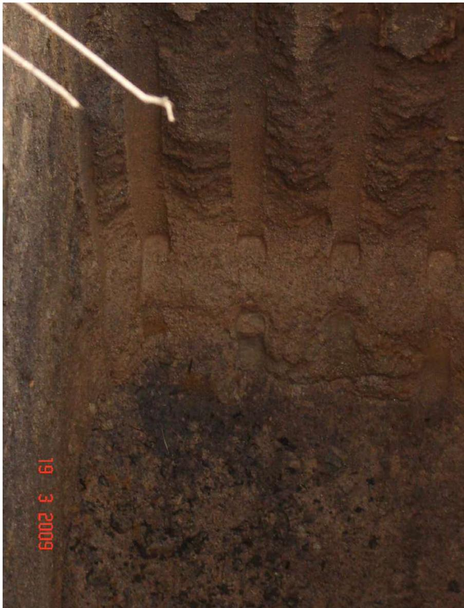
Foto 32 – A imagem mostra a camada de areia média e grossa com pedregulhos e cascalhos finos de cores e litologias variadas na cava da TRI 34 - o material nesta profundidade (~4,0m) se mostra estável e sem presença de água freática. Pouco abaixo desta profundidade ou a aproximadamente 5,0m a camada se mostrava muito permeável e com fluxo ascensional intenso
