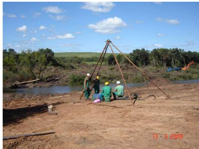
Foto 22 – Vista geral do Arroio Jaguari no trecho da estaca 18 – destaca-se a equipe de sondagens complementares executando um ensaio de infiltração no eixo de barramento e ao fundo o desmatamento da mata ciliar
