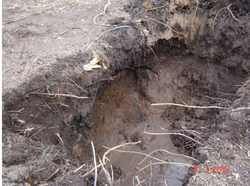
Foto 29 – Idem a foto 24 – neste trecho a camada argilosa orgânica apresenta espessura menor do que 1,0m
