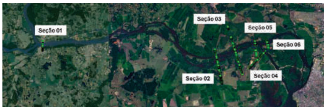
Figura 3.3: Seções transversais com levantamento batimétrico e topográfico do canal principal e planície de inundação qualitativamente as regiões de planície (i.e. baixa declividade) mais suscetíveis a inundação.
