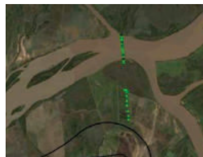
Figura 3.11: Perfil da seção transversal 05 utilizado no modelo HEC-RAS.
