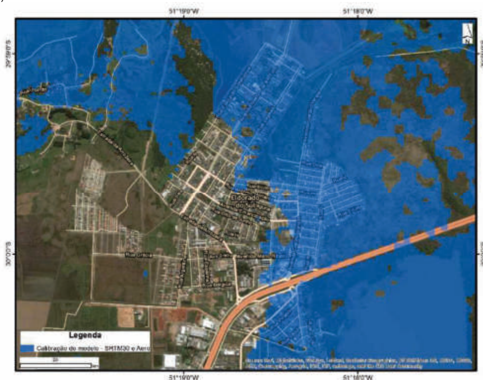
Figura 3.13: Calibração do modelo: mancha de inundação simulada para o evento de Out/2015 (parâmetro de Manning ajustado = 0,030 \text{ s.m}^{-1/3} )
