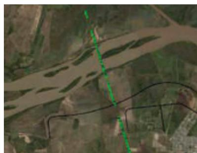
Figura 3.21: Perfil da seção transversal 03 utilizado no modelo HEC-RAS.
