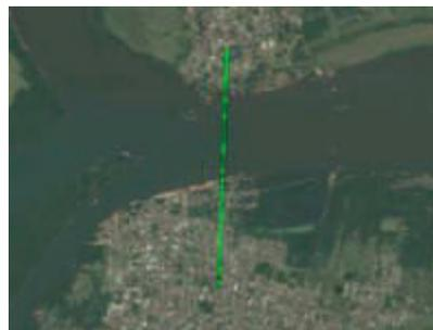
Figura 3.19: Perfil da seção transversal 01 utilizado no modelo HEC-RAS.
