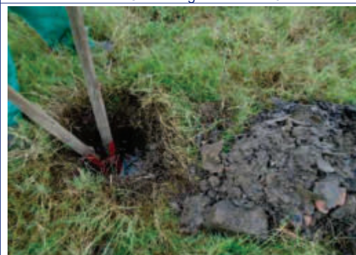
Foto 4.20: Sondagem a Trado 06
