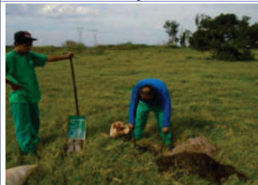
Foto 4.22: Sondagem a Trado 07
