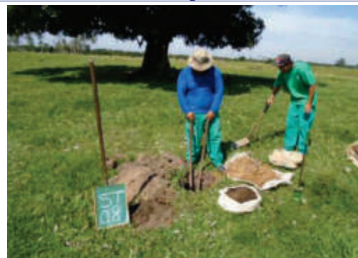
Foto 4.23: Sondagem a Trado 08
