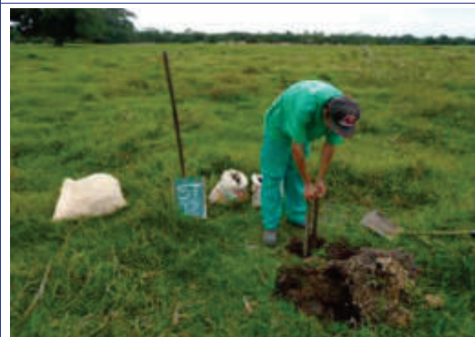
Foto 4.16: Sondagem a Trado 02
