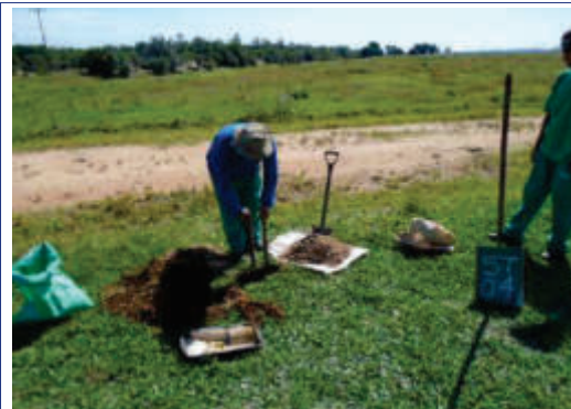
Foto 4.18: Sondagem a Trado 04
