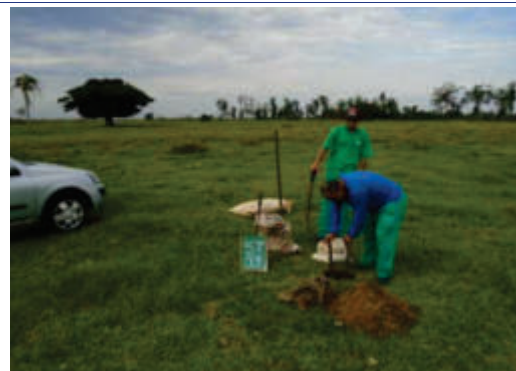
Foto 4.17: Sondagem a Trado 03
