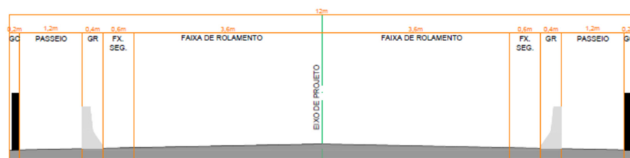
Figura 17: Dimensões da ponte
