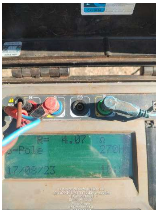
Figura 7 – Leitura de resistência de aterramento no patamar do Armazém A4.
