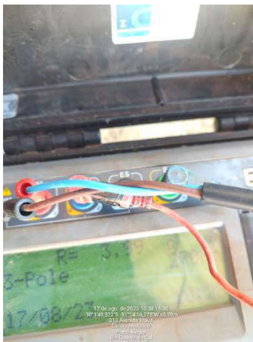
Figura 9 – Leitura de resistência de aterramento no patamar do Armazém A5.
