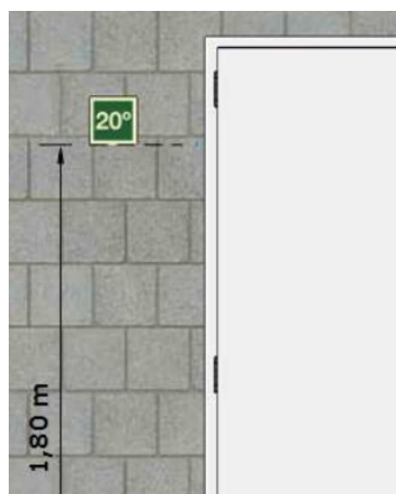
Detalhe da sinalização básica de identificação dos pavimentos
