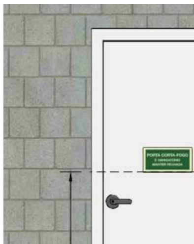
Detalhe da sinalização de porta corta-fogo (ver sinalizações de códigos S20).
