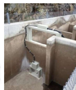
Figura 34 - Esquema de integração de múltiplas antenas e central de armazenamento de dados. Imagem ilustrativa de duas antenas instaladas em escada de peixe com abertura de fundo e superfície bastante similar ao modelo adotado na barragem do arroio Jaguari.
