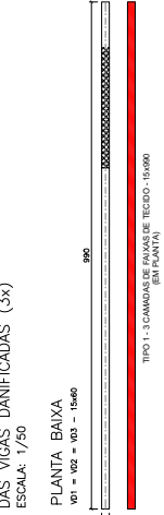
REFORÇO POR MANTA (TECIDO) DE FIBRA DE CARBONO
