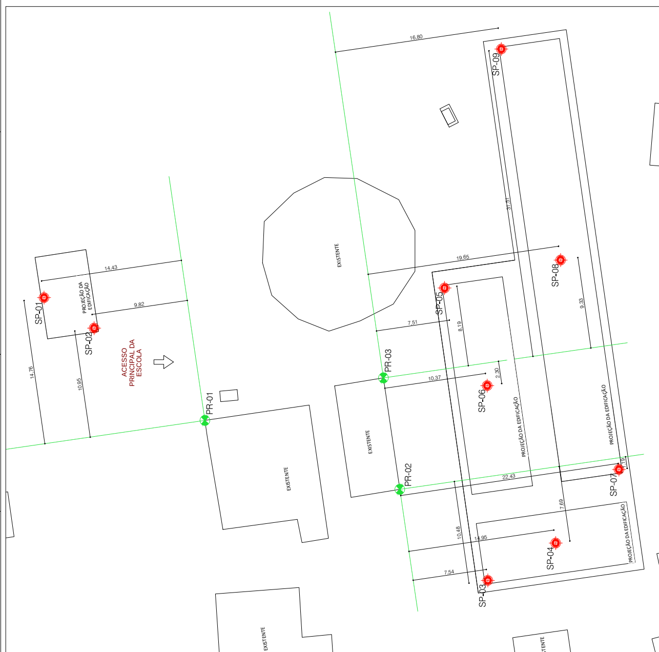
PLANTA DE LOCAÇÃO DOS FUROS DE SONDAGEM
