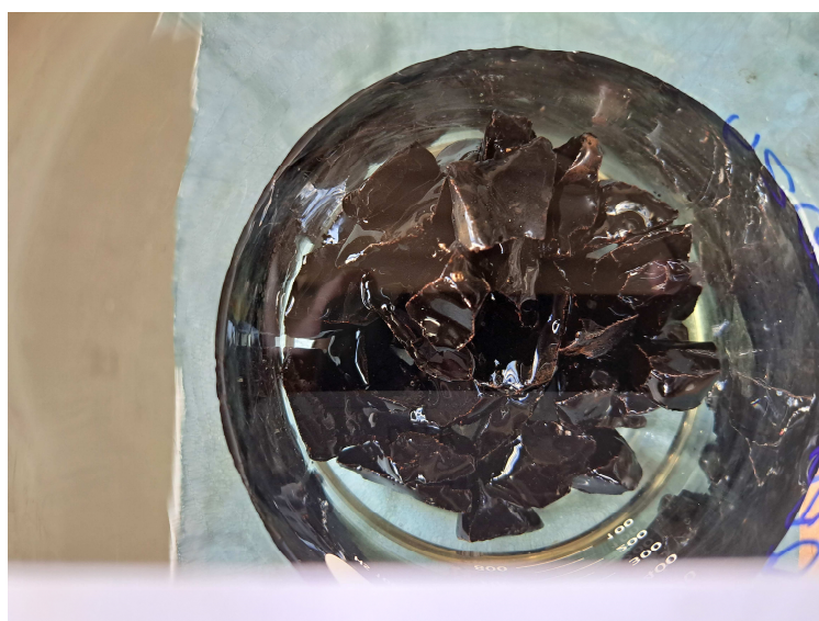
Foto 2- Visualização do resultado da adesividade, utilizando CAP 50/70.
