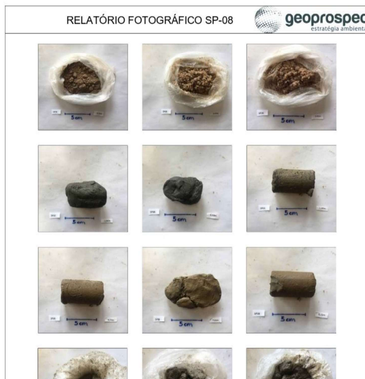
Figura 8. Exemplo de relatório fotográfico das amostras SPT coletadas nas sondagens SP-08, que acompanha o boletim de sondagem.
