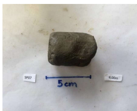
Foto 2. Material argiloso com pouca areia fina, cor cinza escura e consistência mole, encontrada na sondagem SP-07.
