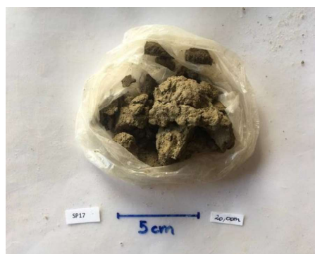
Foto 4. Material areno-argiloso com areia fina a média, cor marrom esverdeada, com consistência dura, encontrado no SP-17.
