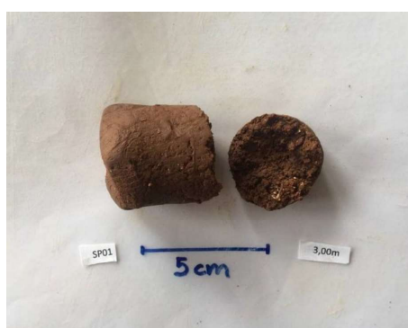
Foto 1. Material argilo-arenoso com areia fina a grossa, cor marrom avermelhada, com consistência média, no SP-001.
