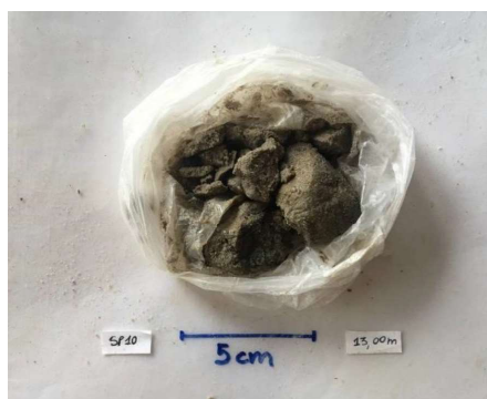
Foto 3. Material com areia fina, cor marrom acinzentada, com consistência medianamente compacta, encontrada no SP-10.
