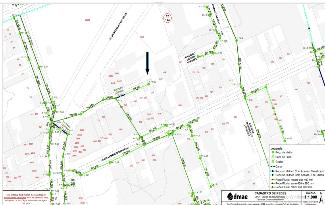
Figura 11 – coletor público de 300 mm – esgoto pluvial
