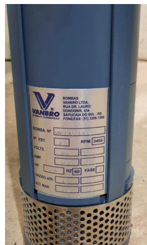
Bomba utilizada para captação de água subterrânea na PME0
