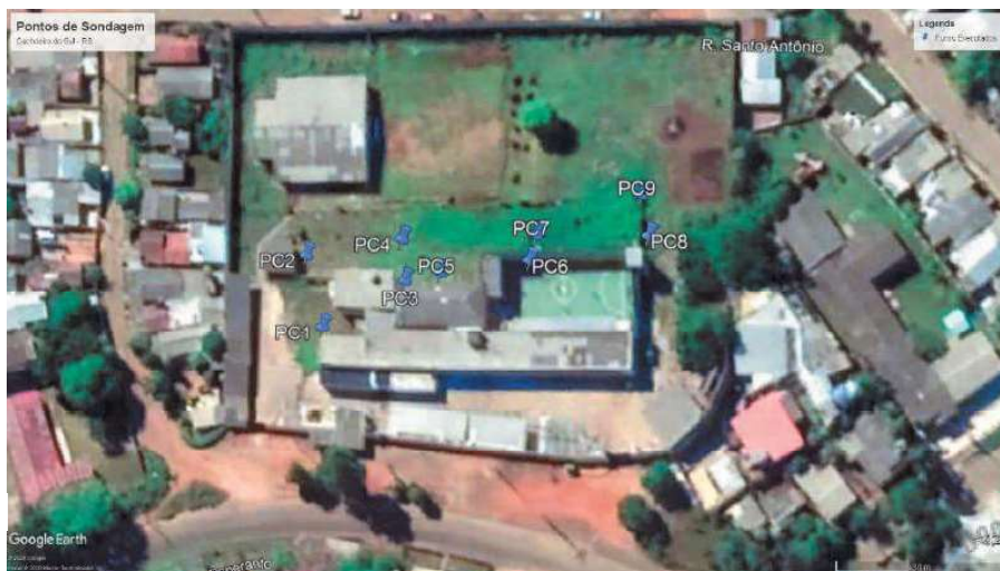
Figura 8 - Localização dos furos (PC's) executados – furo 02 (PC2) foi deslocado devido a presença de cabos de energia no local previamente indicado
