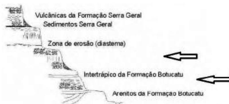
Figura 2.2.4 - Seção geológica esquemática regional dos derrames vulcânicos básicos na Bacia do Paraná, sobrepostos aos arenitos da Fm. Botucatu e/ou em intertrap.
