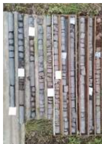
Testemunho Sondagem SR-03
