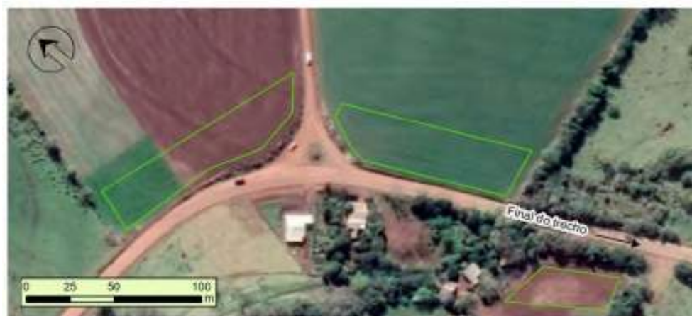
Figura 2.2.23 - Região próximo ao final do trecho, entre as estacas 20+500 e 20+800, com propensão a se tornar jazida de solos lateríticos. Coordenadas UTM 689972E, 6881758N.
