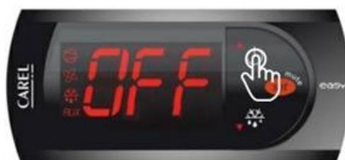
**Para ativar ou desativar o stand by é só pressionar a tecla
