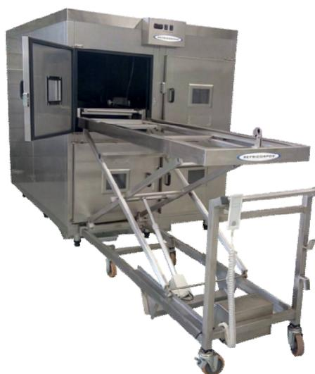
Carro Pantográfico acoplado a Câmara com o trilho travado
