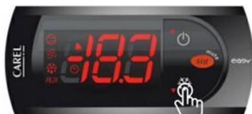
Para ativar o degelo manualmente pressione a tecla ▼ ❄️ por 5 segundos, a indicação DEF será exibida no display do controlador e o ícone ❄️ acenderá indicando que o degelo está em andamento.
