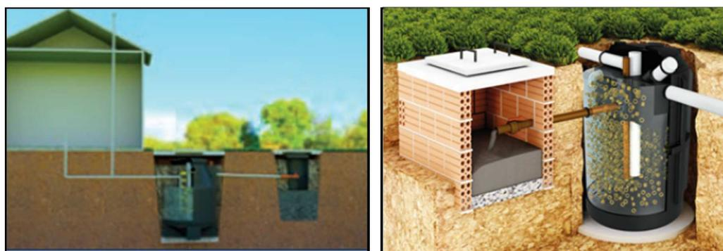
Figura 6 e 7 - ilustração genérica do biodigestor sobre base de concreto e desnível em relação à câmara de lodo, que pode ser fornecida de mais de uma maneira e a saída aérea, sobre o telhado, do biogás
