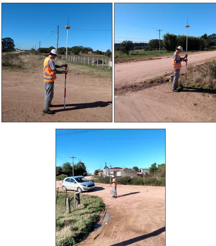
Figura 26 - Levantamento das Seções Transversais
