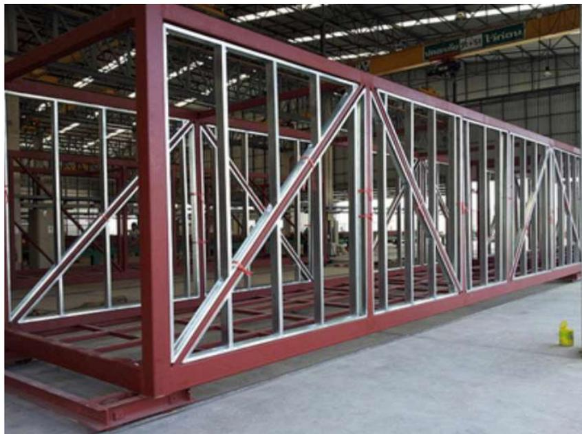
Figura 2 - Módulo volumétrico com aço dobrado a frio e fechamento em LSF (light steel frame). Fonte: Manual de Construção Modular (CBCA, 2022). Disponível em: <https://www.cbca-acobrasil.org.br/site/biblioteca.php?&et=0&emsg=E0010&bsc=ativar&bscPgn=1&bscQtdReg=10&txtBscKeyword=&chkCat%5B0%5D=7#item-102530>
