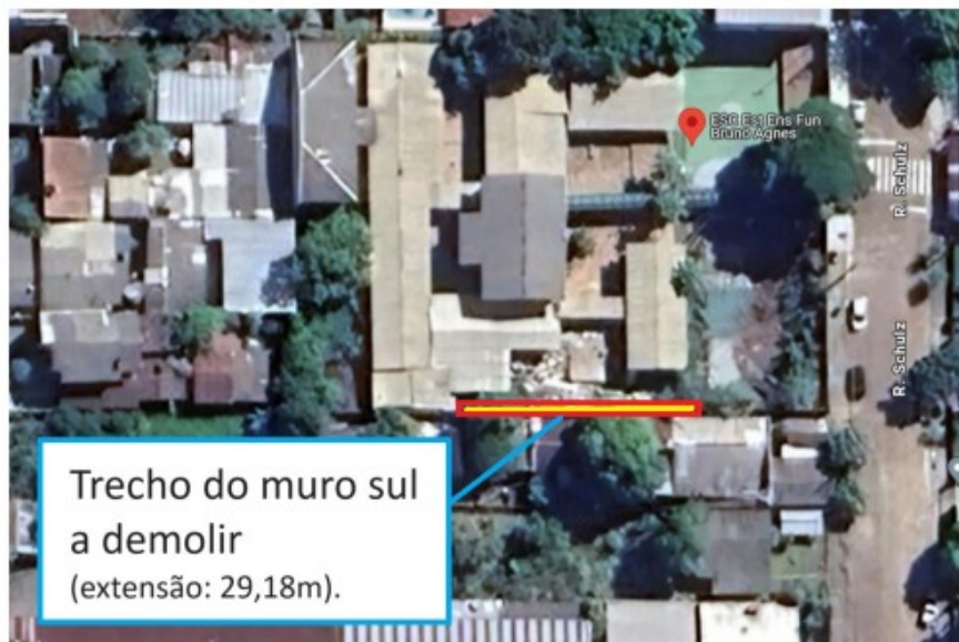
Imagem 01: Indicação do trecho do muro sul a demolir em imagem de satélite.
