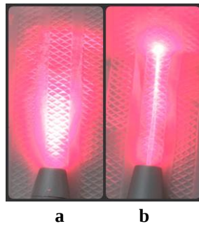
Figura 8 – Laser vermelho 660nm (L1) sendo emitindo quando a ponteira convencional está acoplada na extremidade da caneta (a) e quando a fibra óptica está acoplada (b) (Arquivo pessoal da autora).
