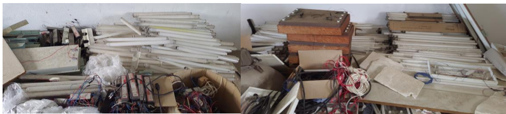
Fotos 3 e 4 – Lâmpadas fluorescentes queimadas inteiras e reatores em locais diferentes da sala
