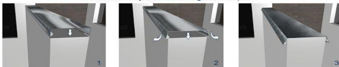
Detalhe de fixação do Rufo Pingadeira Duplo
