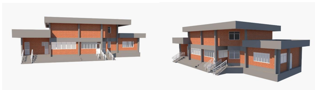
Figura 5 – Adequação dos acessos da edificação administrativa
