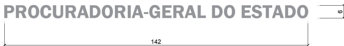
Figura 34. Letreiro 1, tipo caixa em inox, altura 6 cm, profundidade 3cm.
