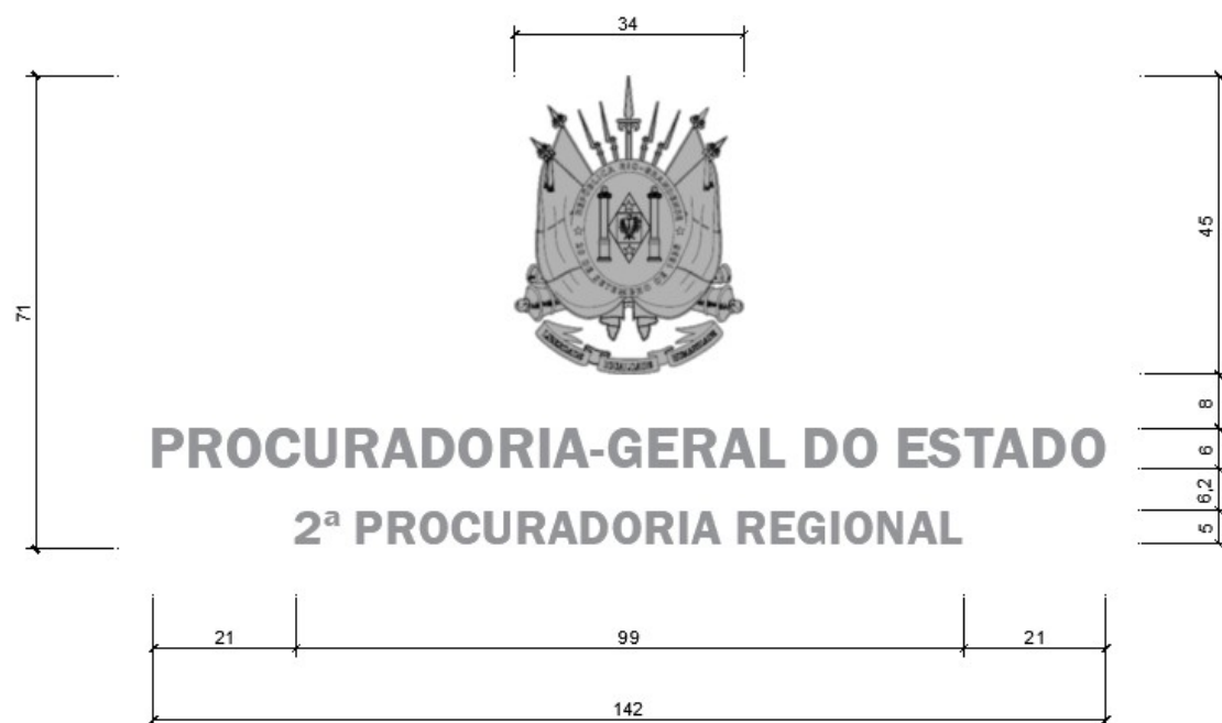
Figura 31. Medidas gerais e distâncias entre os elementos para aplicação do conjunto na parede.
