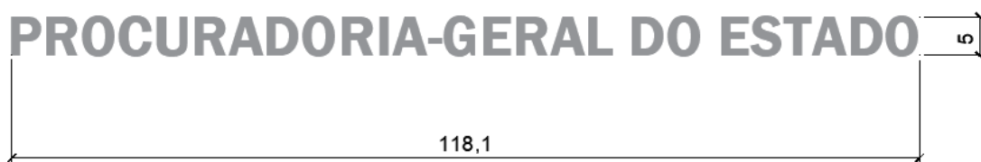
Figura 27. Letreiro 1, tipo caixa em inox, altura 5 cm, profundidade 3cm.
