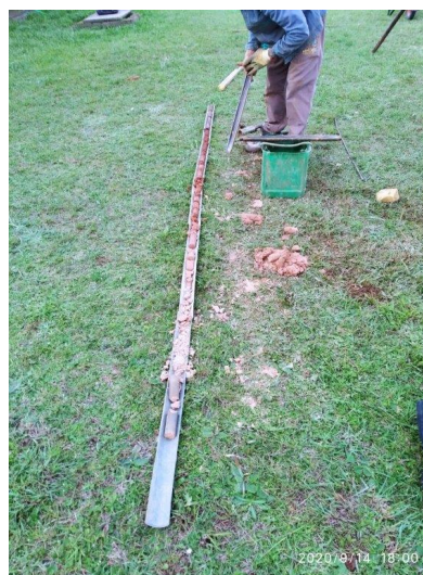
IMAGEM 2 – Amostras acondicionadas provisoriamente em canaletas, para montagem do perfil.
