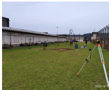
IMAGEM 4 – Vista do nivelamento dos pontos. Tripé montado no segundo ponto (SP2).
