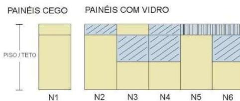
As divisórias utilizadas no interior do prédio do CAFF são compostas por estrutura em alumínio, módulos inferiores em madeira com altura de 1 metro e módulos superiores em vidro (Padrão N4). As divisórias existentes nas salas de trabalho serão realocadas, sendo desmontadas e remontadas conforme o novo layout.
