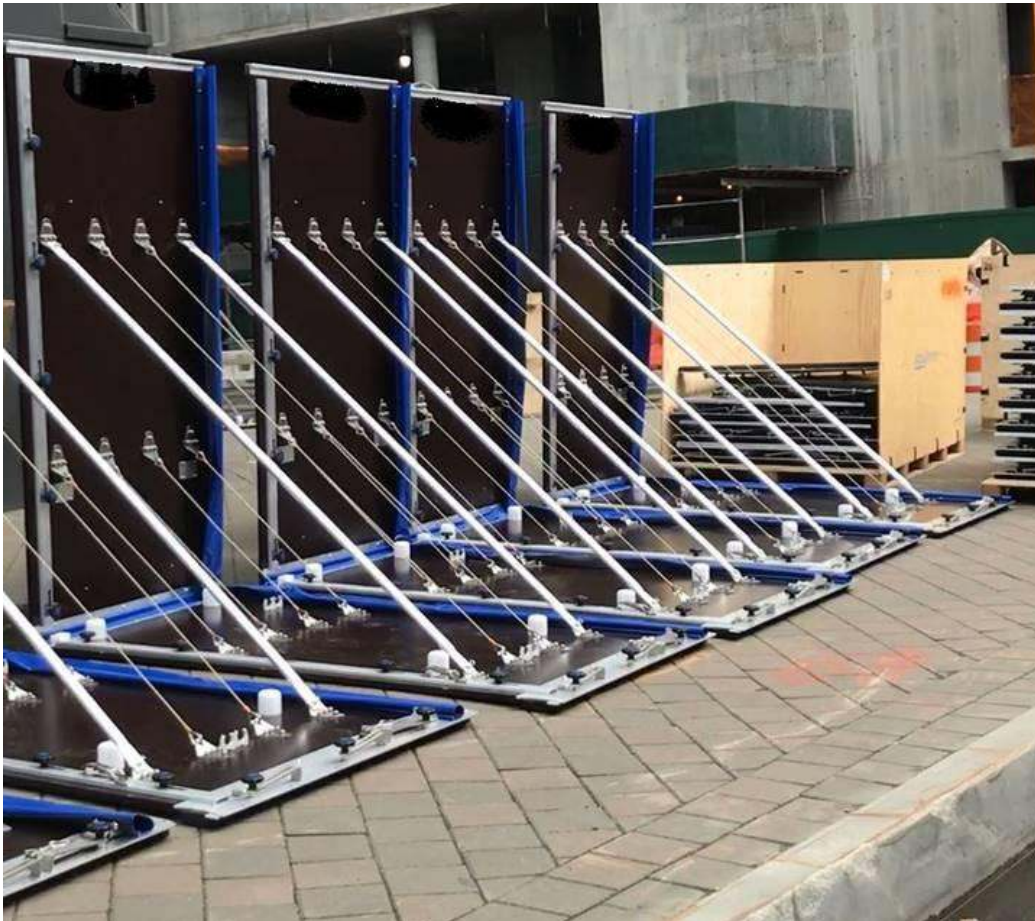
FLOOD-WALL - AQUAFENCE Dispositivo Altura Máxima = 2,40 m Tempo de Montagem: 100 m/h (3 ou 4 pessoas) Não necessita ancoragem Facilidade de armazenamento
