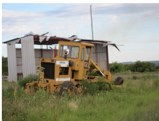
Foto 01: Motoniveladora não desmobilizada.
