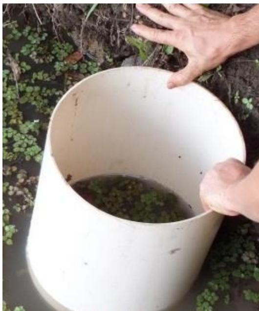
Figura 7 - Delimitador cilíndrico que poderá ser utilizado para coleta de macrófitas.
