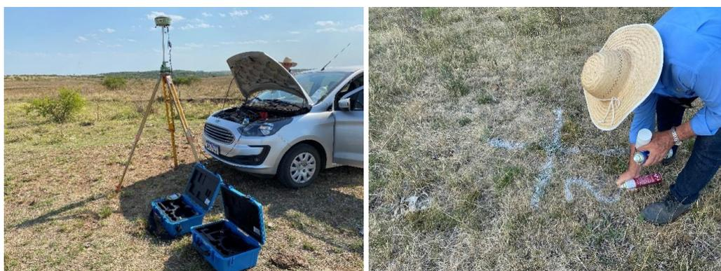
Figura 98 – Posicionamento do GPS e marcação de pontos de controle.
