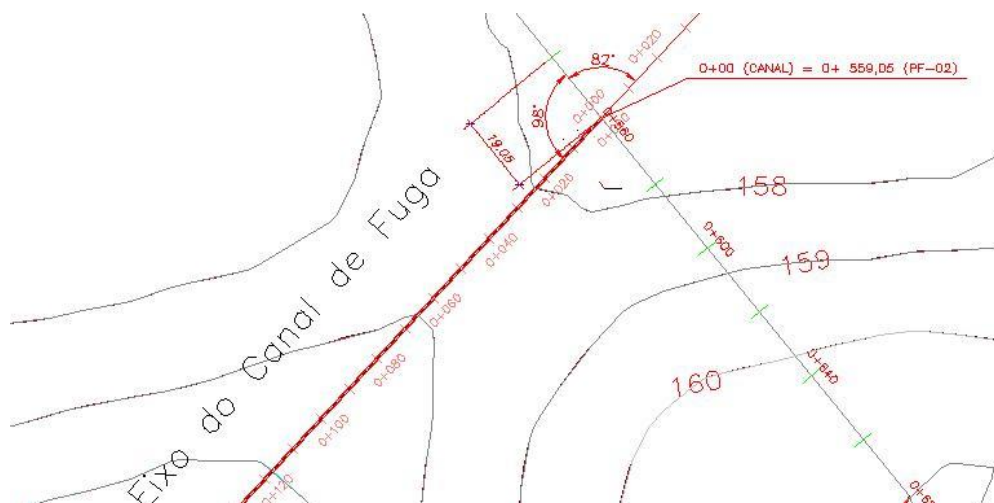
Figura 6 – Elementos Locacionais do Canal de Fuga
