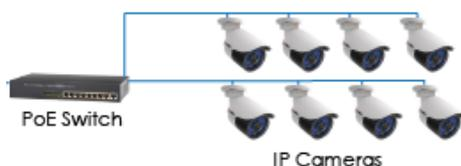
Figura 32: Instalação das câmeras
