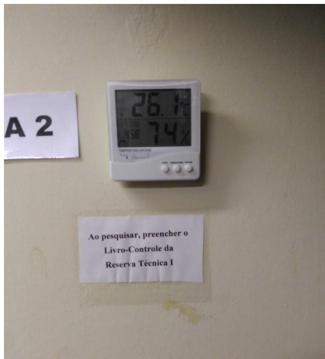
Figura 120 - Termo-higrômetro. Fonte do autor
