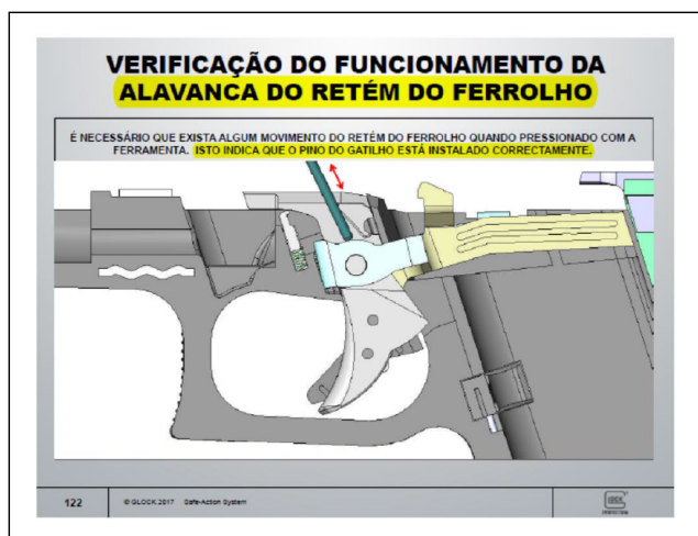
As ilustrações têm como única finalidade a verificação da funcionalidade da mola do retém, através do posicionamento do retém no local adequado e limpo, afim de evitar que ao final da montagem da pistola, o processo tenha que ser reiniciado.
