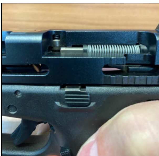
Pronta para disparo - “percursor semitensionado”
