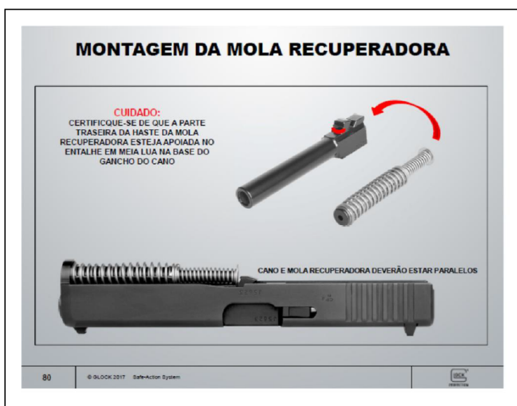
A ilustração tem como única finalidade indicar o local desejado, traduzido no entalhe em meia lua, buscando facilitar sua montagem
