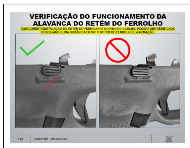
As ilustrações têm como única finalidade a verificação da funcionalidade da mola do retém, através do posicionamento do retém no local adequado e limpo, afim de evitar que ao final da montagem da pistola, o processo tenha que ser reiniciado.
