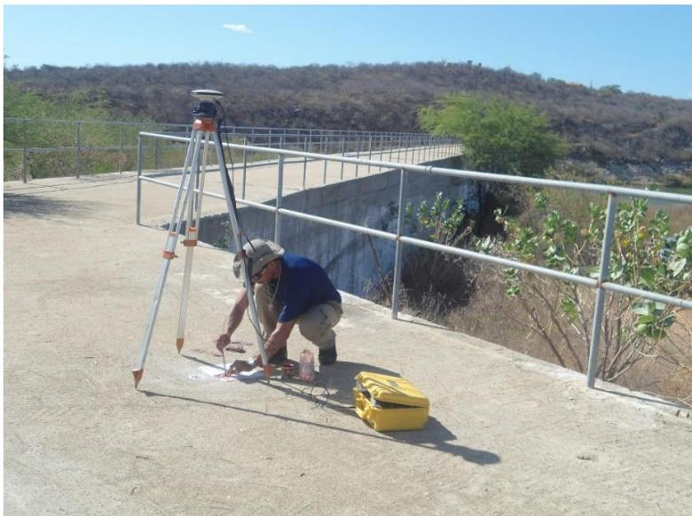
**Figura 22: Determinação altimétrica de uma RRNN da seção de régua dos corpos hídricos e dos pontos de afluência e defluência**
