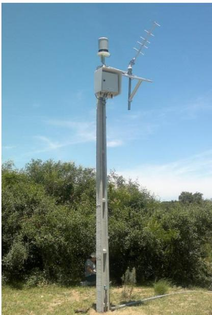
**Figura 17: Instalação da PCD em poste alto, de concreto, na Estação Rosário do Sul, RS**
