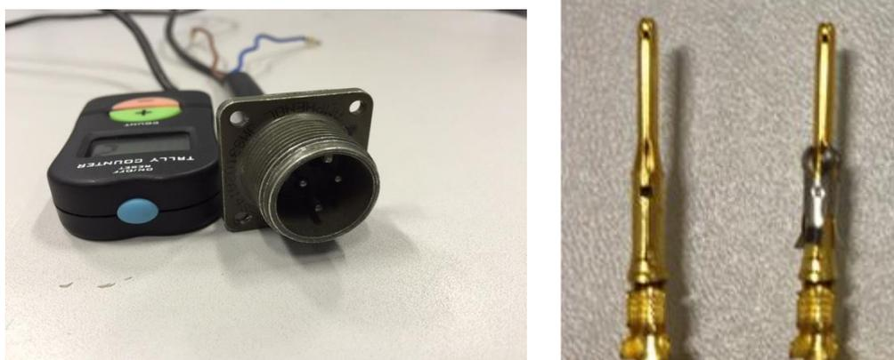
Figura 7: Detalhe do conector e detalhe dos terminais
