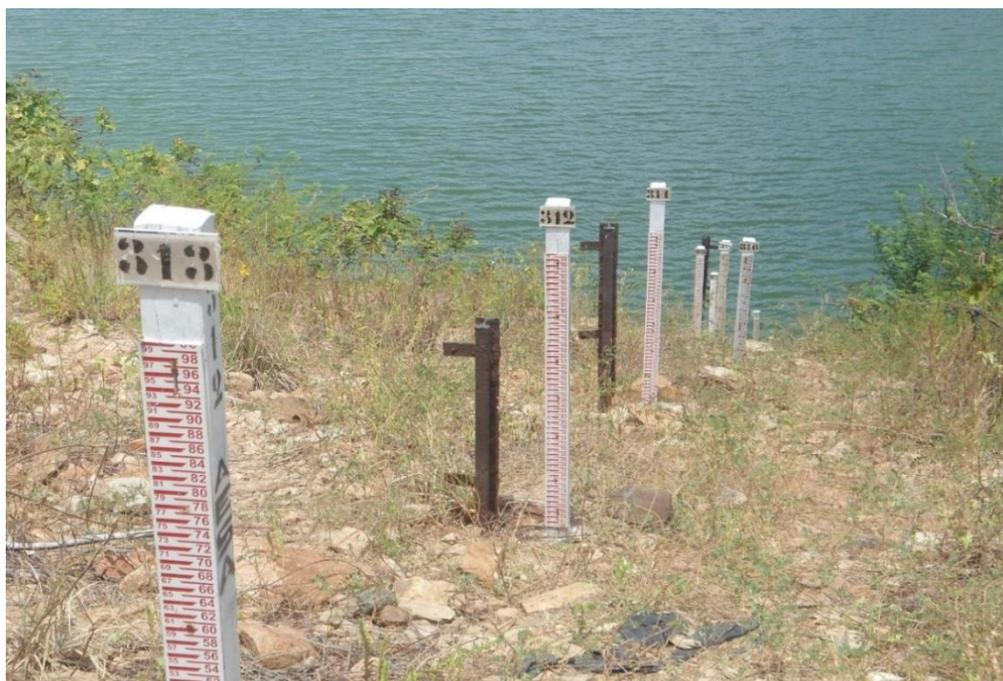
**Figura 20: Seção de réguas limnimétricas**
