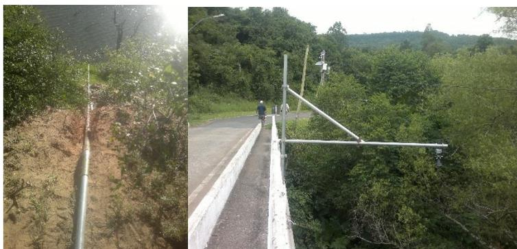
**Figura 15: : Tubulação de proteção do sensor de nível d'água: tipo transdutores de pressão, à esquerda (Estação Passo dos Farrapos, RS) e radar ultrassônico, à direita (Estação Picada Café, RS)**
